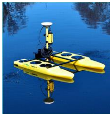
Fig. 2 Ecosonda Valeport Midas Surveyor
